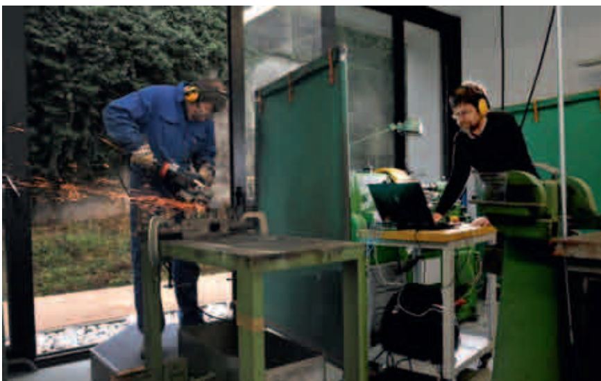
Mesure et diagnostic vibratoires de machines portatives pour le développement d'une base de données
