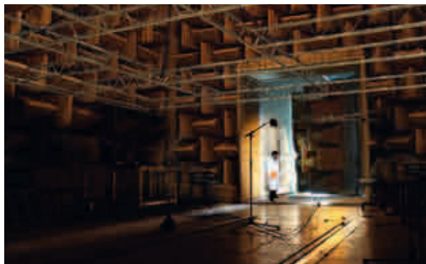
Chambre semi-an choique pour la r alisation d'essais acoustiques
