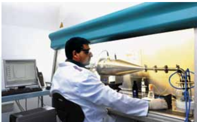
Générateur de bioaérosols conçu par l'INRS
