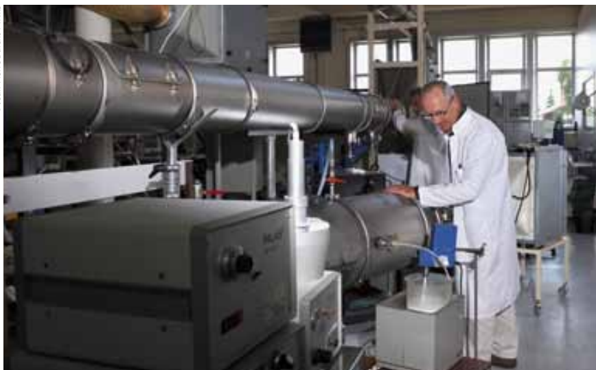
Analyse de polluants particulaires dans des conduits de ventilation
