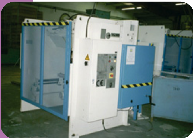
Figure 16 : Exemple de protection de la face arrière.
