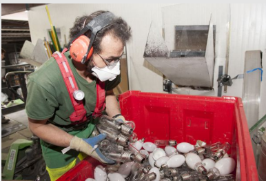
Travailleur équipé d'un dispositif de prélèvement lors d'une activité de recyclage
