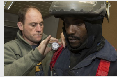
Pose d'une cassette sur un harnais de prélèvement
