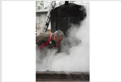
Travailleur équipé d'un dispositif de prélèvement individuel lors du nettoyage d'une cuve
