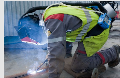
Travailleur équipé d'un dispositif de prélèvement lors d'une opération de soudage
