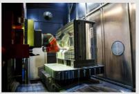
© Vincent Nguyen pour l'INRS - 2020 Machine d'usinages dans une enceinte confinée reliée à une unité centralisée d'aspiration des brouillards d'huile générés par l'utilisation de fluides lubrifiants
