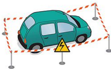
Balisage autour d'un véhicule électrique présentant une pièce nue sous tension
