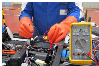
Mesure de tension aux bornes d'une batterie de véhicule électrique
