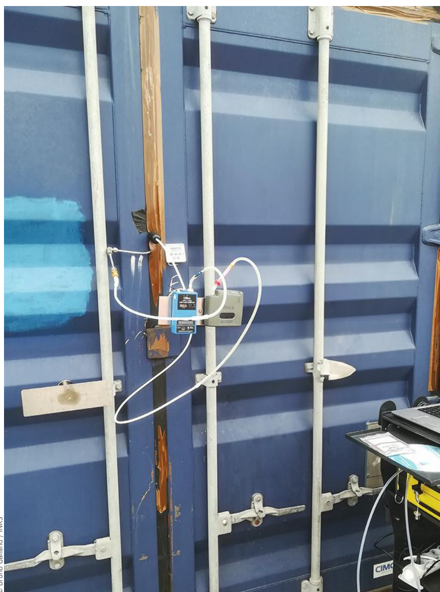
↑ FIGURE 1 Exemple de mesures sur un conteneur posé au sol. Deux sondes permettent de connecter des pompes de prélèvement pour la réalisation de deux prélèvements en parallèle, un pour l'échantillonnage de COV et le second dédié aux alcools. Ces échantillons seront analysés ultérieurement en laboratoire. Sur la droite de la photographie, l'analyseur temps réel de type FTIR et son ordinateur de pilotage. À noter la présence sur les joints de portes d'un reste de ruban adhésif (marron), pouvant indiquer que ce conteneur a pu faire l'objet d'une opération de fumigation par le passé.
