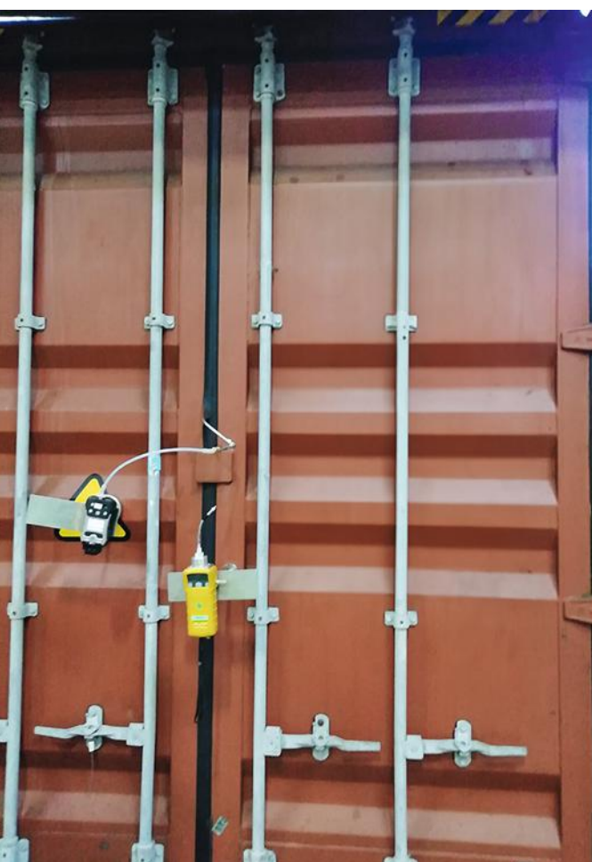
↑ FIGURE 3 investigation à l'aide de deux détecteurs à lecture directe grâce à deux sondes introduites entre les portes du conteneur. Les détecteurs sont maintenus en place durant la mesure (minimum une minute) à l'aide de supports aimantés.
