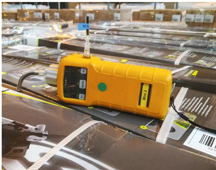
↑ FIGURE 2 La sonde d'un détecteur à photo-ionisation (PID) pourvu d'une pompe interne est introduite dans un des cartons sortis du conteneur. En aval du PID (dont le principe de mesure est non destructif), un TCA (identifié par une étiquette bleue) piège les COV émis avant analyse en laboratoire.
