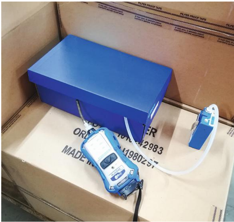
↑ FIGURE 8 Suivi de l'émission de COV par des chaussures neuves à l'aide d'un capteur PID à lecture directe, et qualification des composés émis par prélèvement sur un tube de charbon actif.
