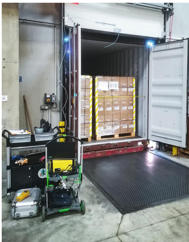
↑ FIGURE 4 Conteneur de seringues, portes ouvertes. En haut de la photographie, le tube de prélèvement permettant une mesure par le FTIR (en jaune au premier plan) de l'OE.
