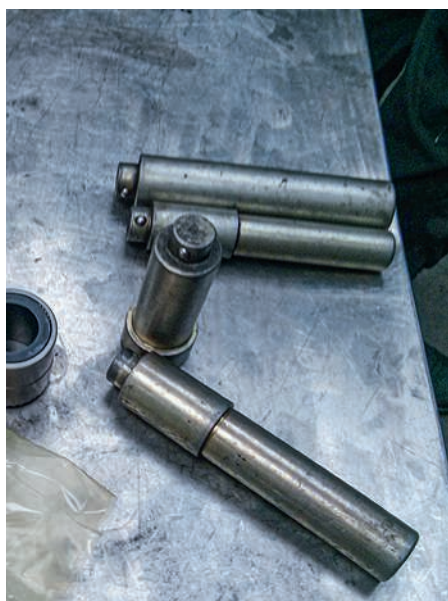
↑ FIGURE 4 Bouterolles pour presse à pivot. À droite : bouterolle montée sur la presse.
