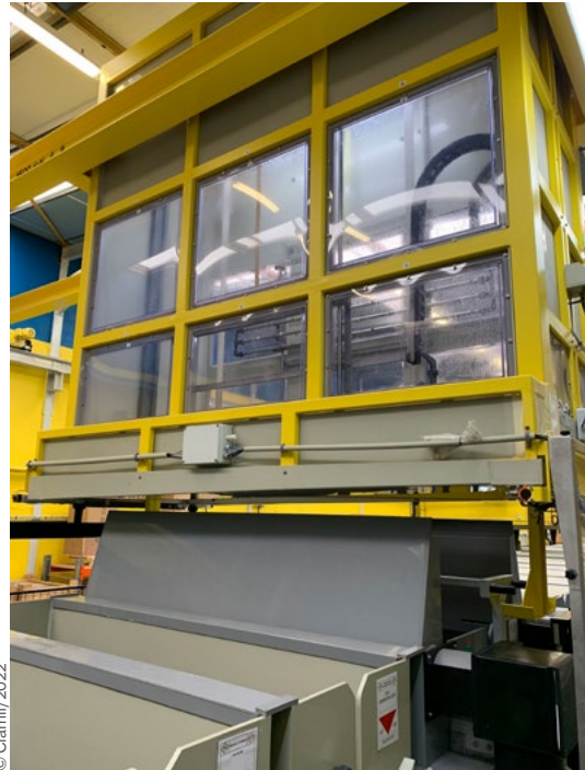
■ Photo 3. Ouverture des couvercles et remontée des pièces dans l'enceinte de rinçage
