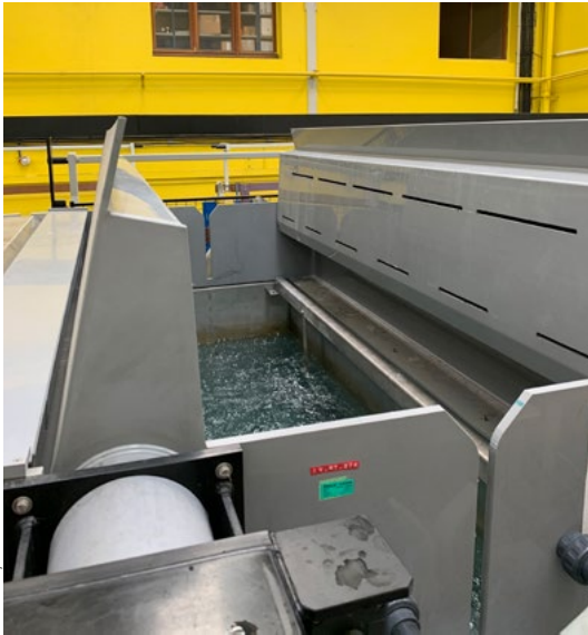
■ Photo 2. Cuve ouverte avec dispositif de captage bilatéral
