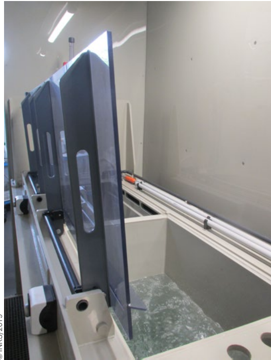
■ Photo 11. Bains et couvercles servant de protection
