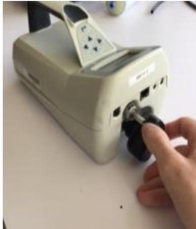
Figure 4 : Installation de la cartouche d'isopropanol
