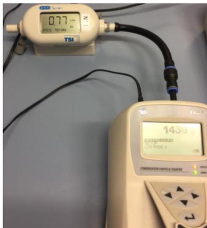
Figure 5 : Vérification du débit du CNC
