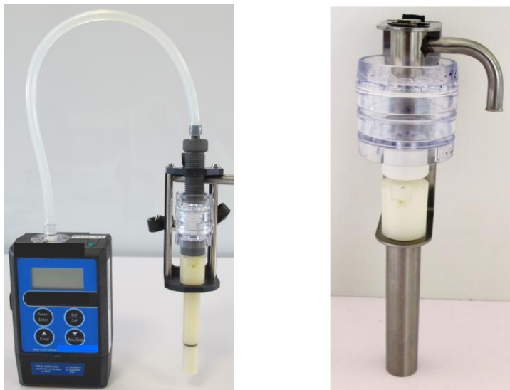
Figure 10 : Photographies illustratives d'un cyclone 10 mm Dorr-Oliver. Plusieurs dispositifs porte-cyclone peuvent être rencontrés.
