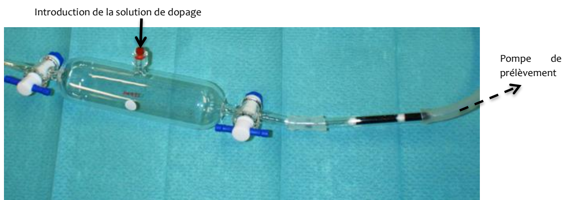
Figure 2 : Exemple de montage pour le dopage des tubes
