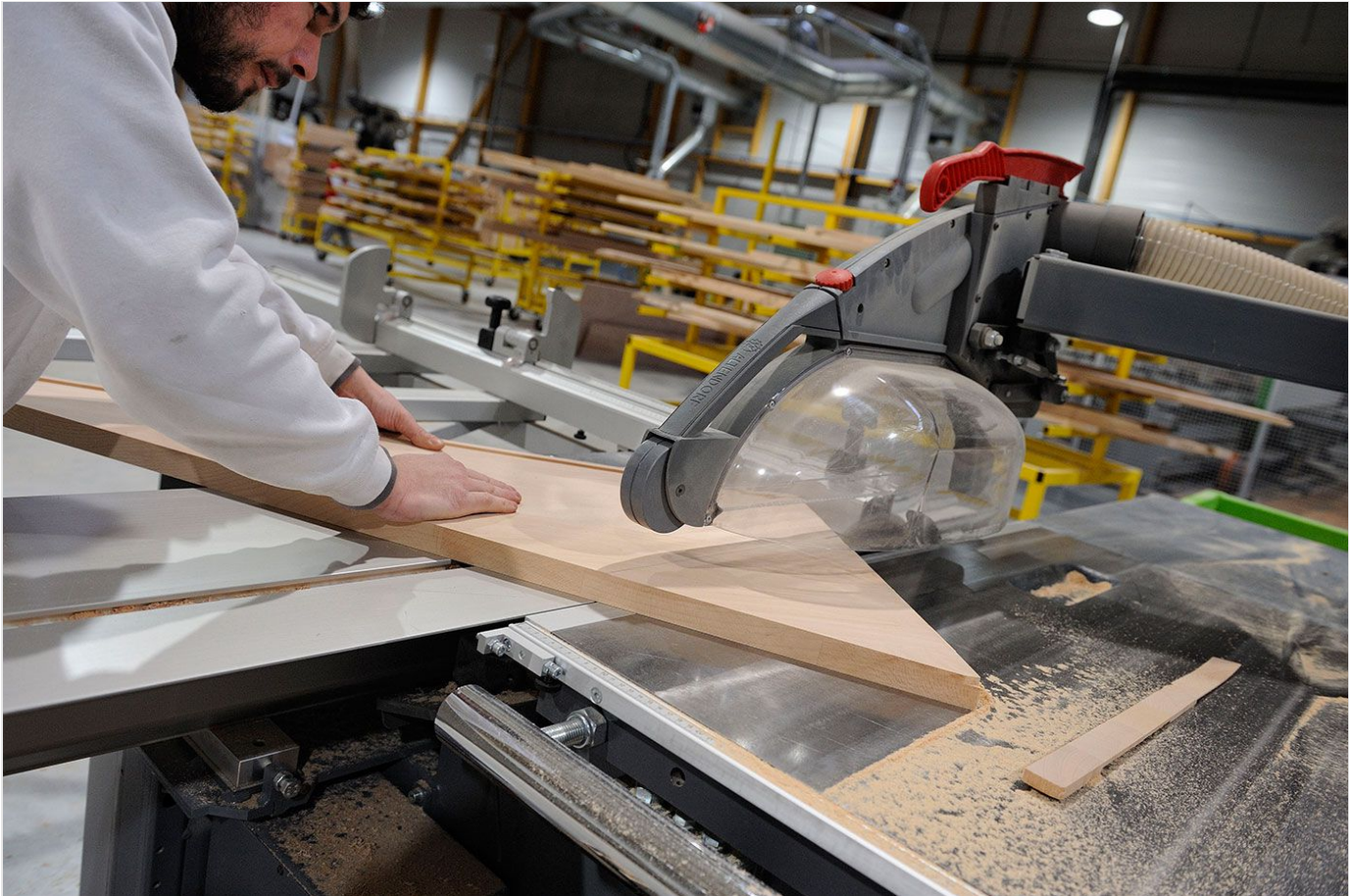
© Patrick Delapierre pour l'INRS / 2010 Dispositif de captage des poussières sur une scie
