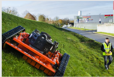
© Philippe Castano pour l'INRS / 2017 Robot de tonte télécommandé
