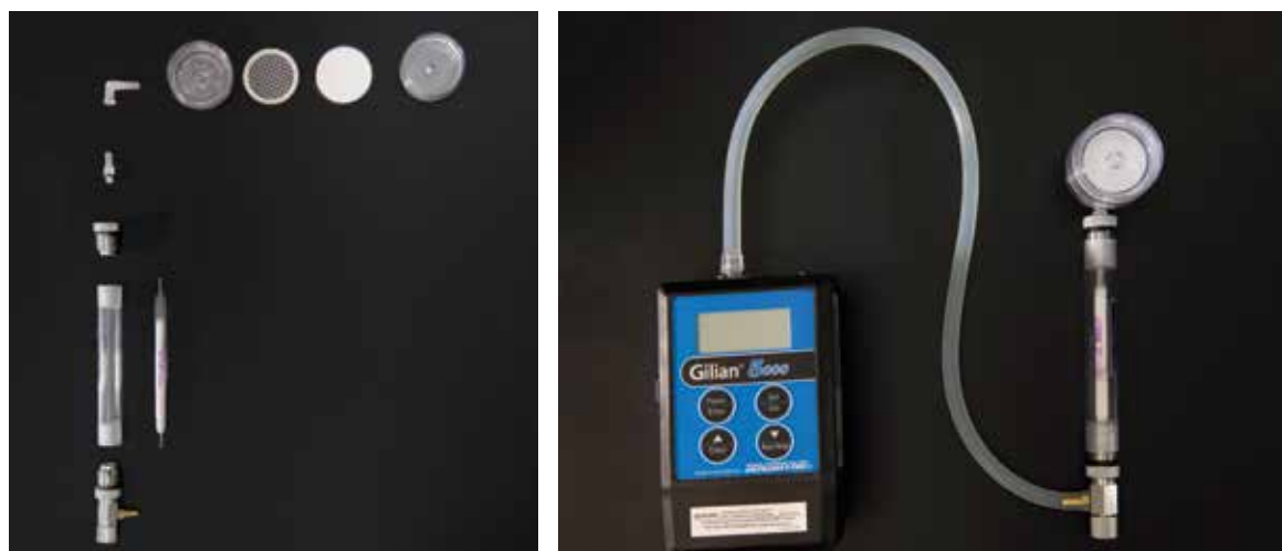
↑ FIGURE 1 Vue éclatée et complète du dispositif de prélèvement préconisé par la méthode MétroPol M-2 [5].
