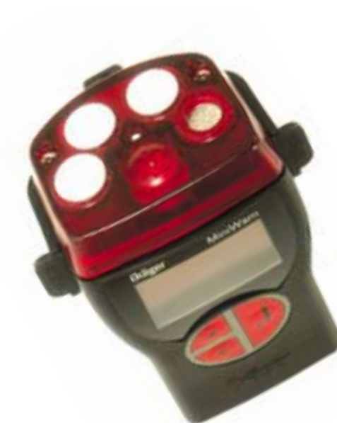
Figure 4. Détecteur multi-gaz MiniWARN Draeger : 3 capteurs électrochimiques, 1 capteur catalytique, 1 capteur infra-rouge.
