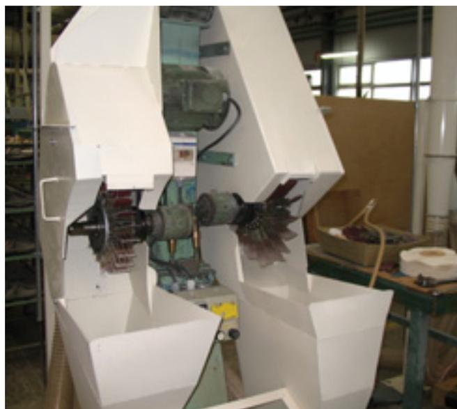
**PONCEUSE (APRÈS)** Un captage enveloppant largement les zones d'émission et d'éjection des poussières, une prise en compte d'une place suffisante pour les pièces et une augmentation du débit (3 900 m<sup>3</sup>/h) ont permis une diminution considérable de l'empoussièrément (0,6 mg/m<sup>3</sup>).
