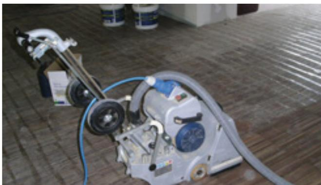
Ponceuse avec dispositif de captage des poussières.
