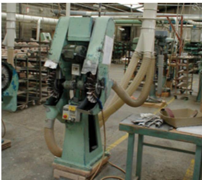
**PONCEUSE (AVANT)** Le dispositif de captage d'origine qui équipe cette ponceuse ne tient pas compte du sens d'éjection des poussières et des particularités des pièces à poncer. De plus, le dispositif de captage n'est pas suffisamment au niveau des brosses et le débit de 1 900 m<sup>3</sup>/h est insuffisant. Il en résulte un empoussièrément au niveau de l'opérateur d'environ 6 mg/m<sup>3</sup>.
