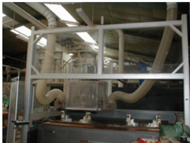
**CENTRE D'USINAGE (APRÈS)** Deux capteurs ont été installés au plus près des outils de coupe et d'autres capteurs ont été installés sur la table où sont fixées les pièces à usiner. L'optimisation de la forme et de la position des capteurs a permis de réduire le débit d'aspiration à 5 100 m<sup>3</sup>/h tout en réduisant l'empoussièrément à 0,4 mg/m<sup>3</sup>.
