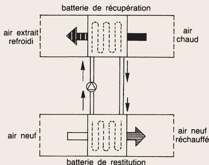
Figure 6. Schéma d'un échangeur à double batterie
