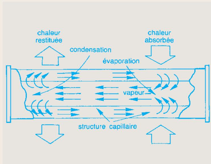
Figure 7. Schéma d'un caloduc horizontal
