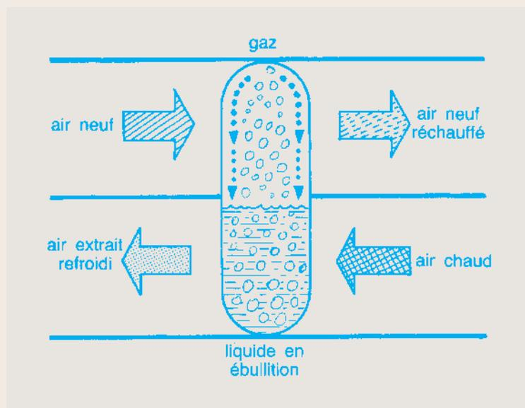
Figure 8. Schéma d'un caloduc vertical
