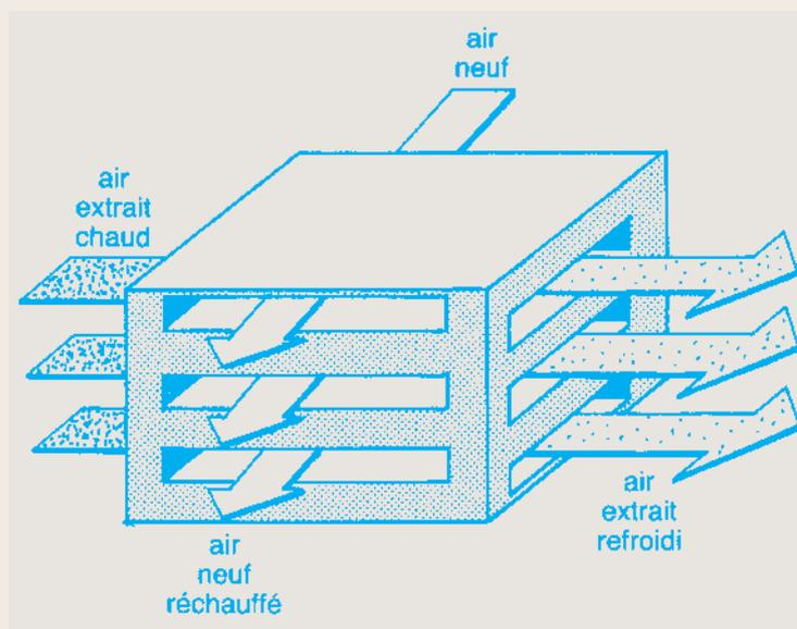
Figure 4. Schéma d'un échangeur à plaques
