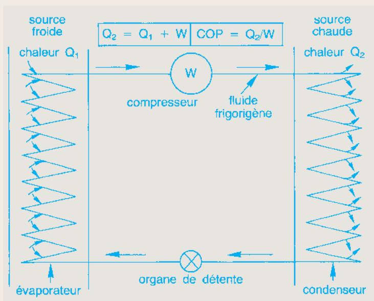
Figure 9. Schéma de fonctionnement de la pompe à chaleur
