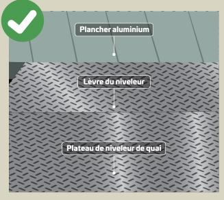
Enfin, des expérimentations ont montré qu'il faut éviter que **le plancher de la remorque** soit plus bas que le sol du quai, et que le plateau du niveleur soit en légère descente, car cela génère des niveaux vibratoires importants. Idéalement :
