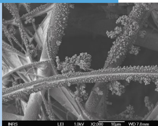
▲ Figure 25. Nanoparticules de cuivre collectées sur des fibres d'un filtre (observées en microscopie électronique à balayage)
