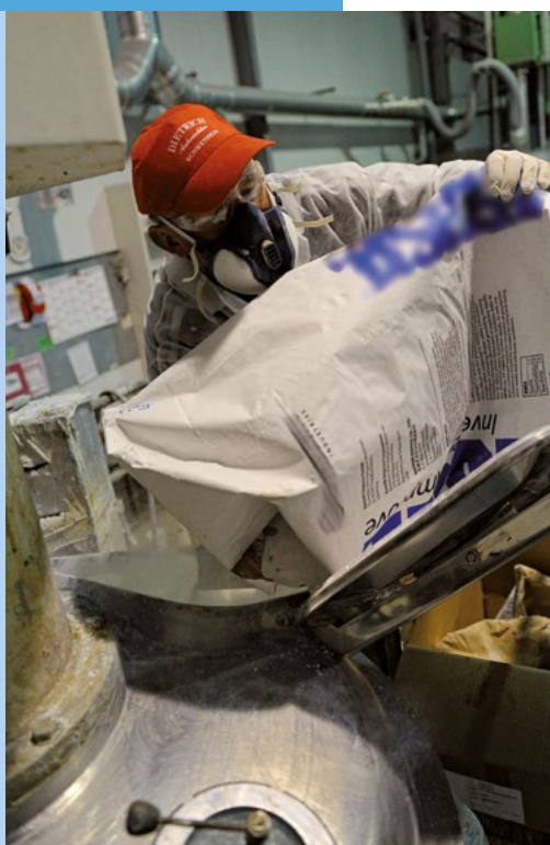
▲ Figure 31. Les contenants vides sont considérés comme des déchets de nanomatériaux.
