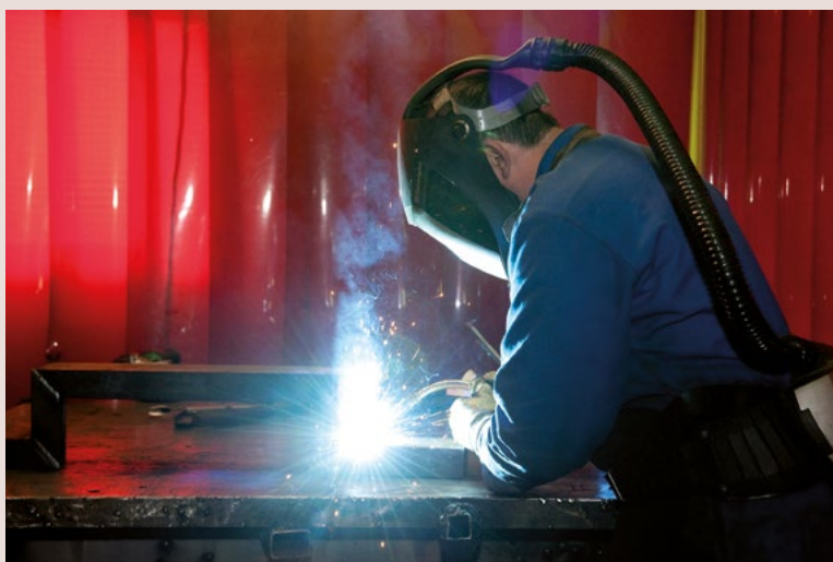
◀ Figure 11. Opération de soudage à l'arc
