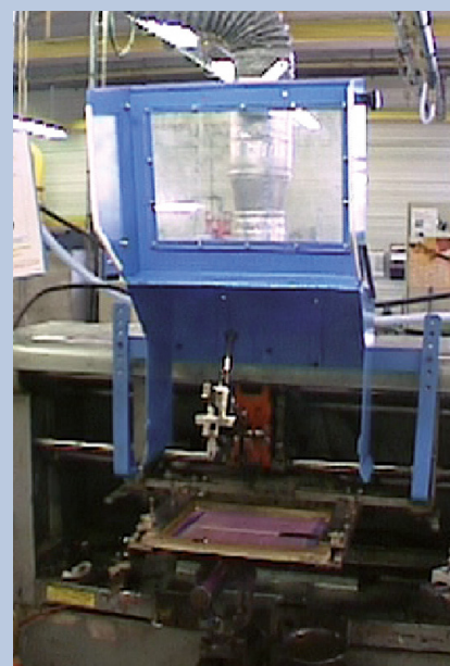
Le dispositif se soulève afin de faciliter le nettoyage de l'écran d'impression.
