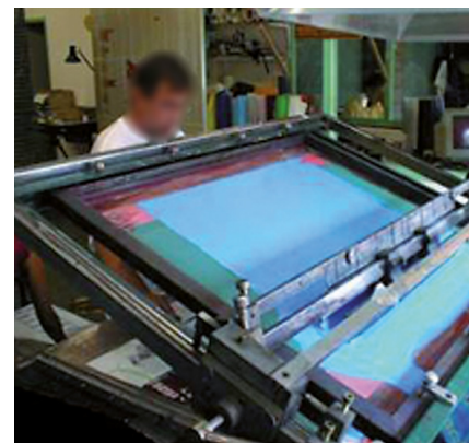
Photo 2. Machines à support fixe avec basculement de l'écran.
