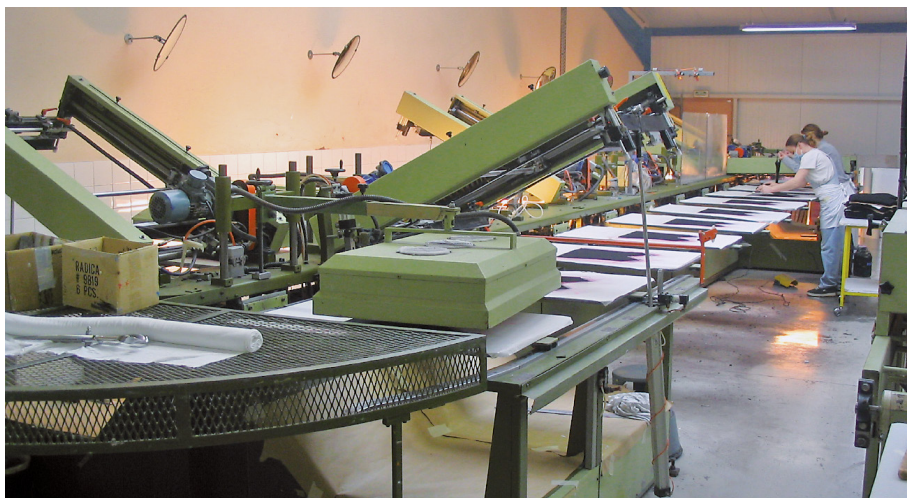
Photo 1. Modèle de machines de sérigraphie avec un carrousel.
