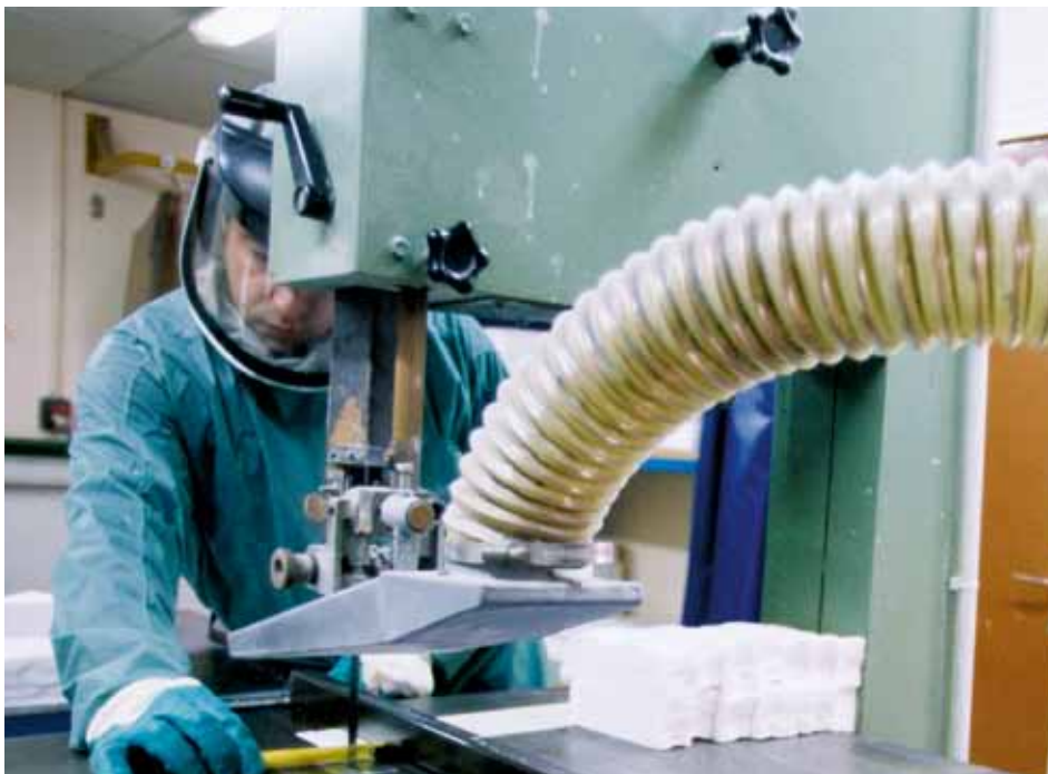
Découpe de pièce en fibres céramiques réfractaires : les mesures de protection collective (aspiration au point d'émission notamment) doivent être complétées par le port de protections individuelles (gants, masque, combinaison, lunettes).
