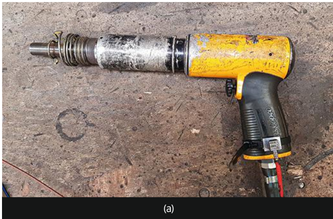
↑ FIGURE 2 Marteau à river Atlas Copco RRH 12 (a) et marteau burineur Atlas Copco RRC 75 B-01 (b).
