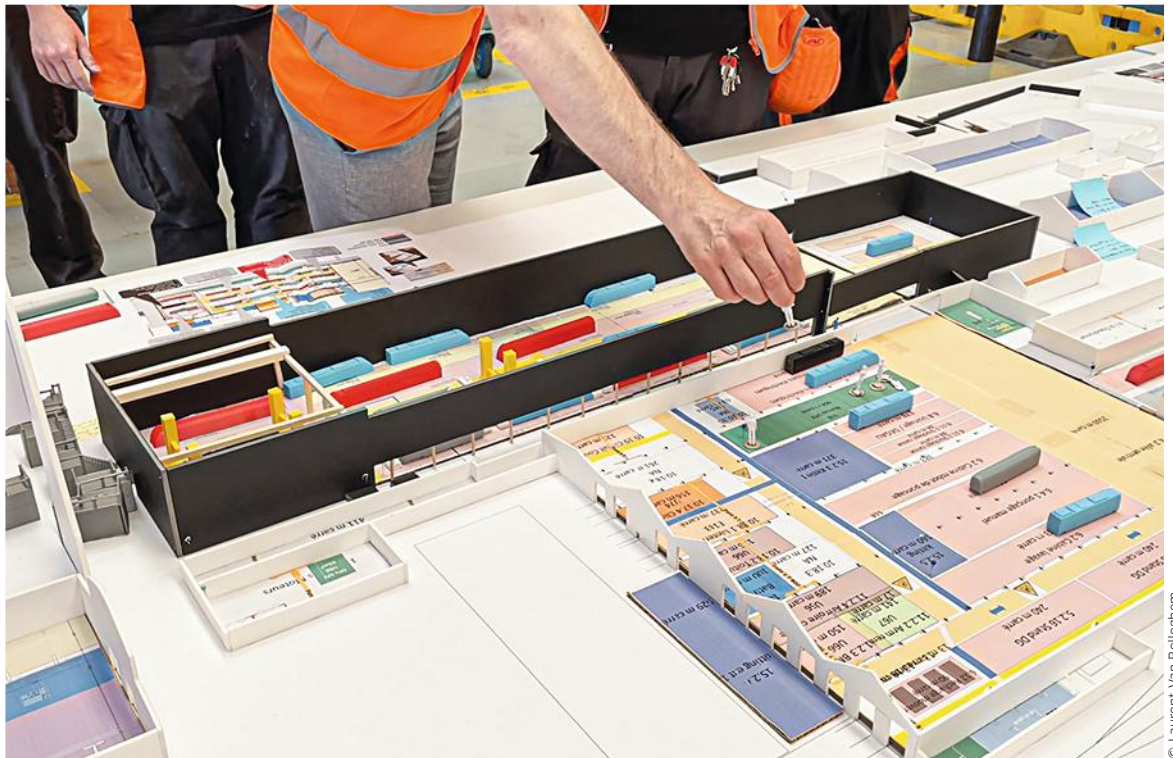
Illustration d'un dispositif de simulation en milieu industriel mettant en œuvre des avatars sur une maquette.
