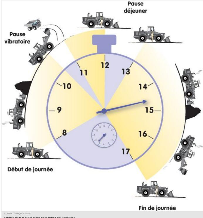
Estimation de la durée réelle d'exposition aux vibrations
