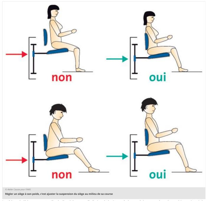
Les réglages de déplacement avant-arrière du siège, de hauteur et d'inclinaison du dossier sont également très importants : le conducteur doit pouvoir atteindre les pédales sans effort. Dans le cas où des équipements sont prévus à l'intérieur de la cabine, ceux-ci doivent être facilement accessibles en position assise.
