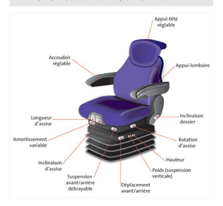
Siège d'un engin et ses réglages, permettant de diminuer la transmission de vibrations au conducteur
