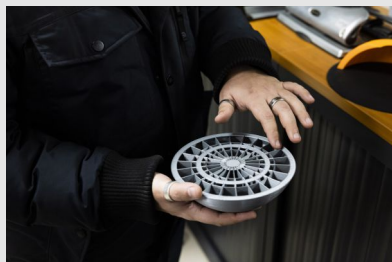
© P. Castano/INRS/2021 Pièce métallique réalisée par fabrication additive
