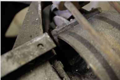
Mâchoires de frein d'un moteur d'ascenseur
