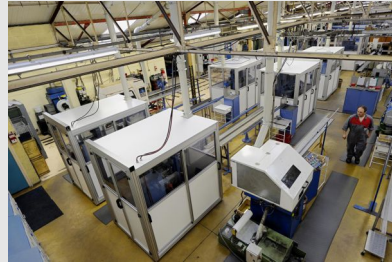
Encoffrement de machines pour éviter les projections nocives
