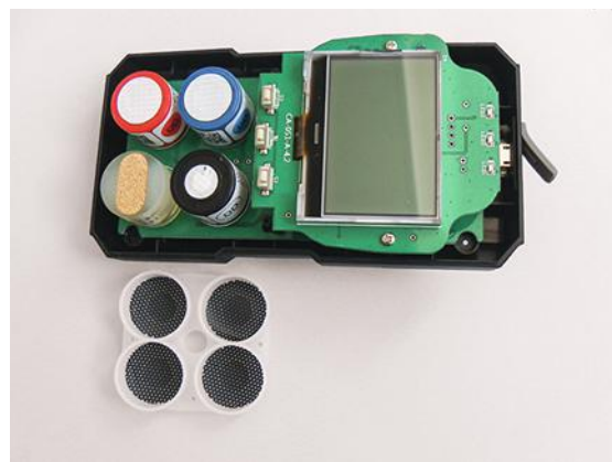
↑ FIGURE 14 Configuration où les capteurs sont positionnés directement au niveau de la carte principale. Les capteurs bleu (H 2 S), rouge (CO) et noir (O 2 ) sont facilement retirables, le capteur catalytique (ovale doré) est soudé sur la carte.
