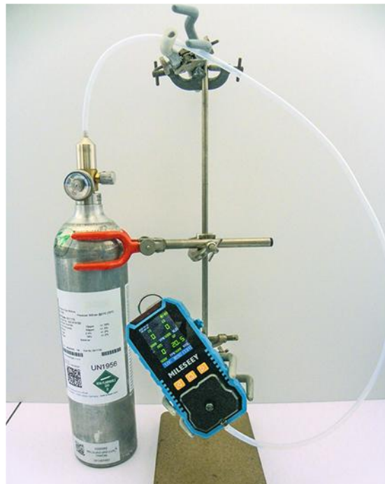
← FIGURE 3 Montage type utilisé pour le test de référence mais aussi pour déterminer la réponse des DSBC à différents gaz inflammables. Le détendeur délivre un débit fixe de gaz de 0,5 dm 3 .min -1 via une tubulure en téflon d'environ 1 m de longueur et de diamètre intérieur = 4 mm.
