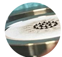
↑ Photographie d'un aérosol collecté sur un étage d'impaction d'un impacteur en cascade.
