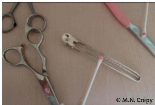
Photo 3 : Spot test positif au nickel sur certains ciseaux et clips utilisés en salon de coiffure.
