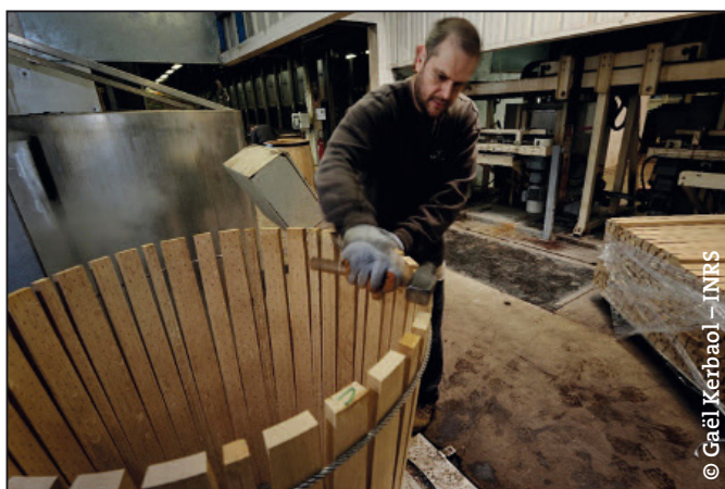
Photo 1 : Martelage manuel lors de la fabrication de tonneau.
