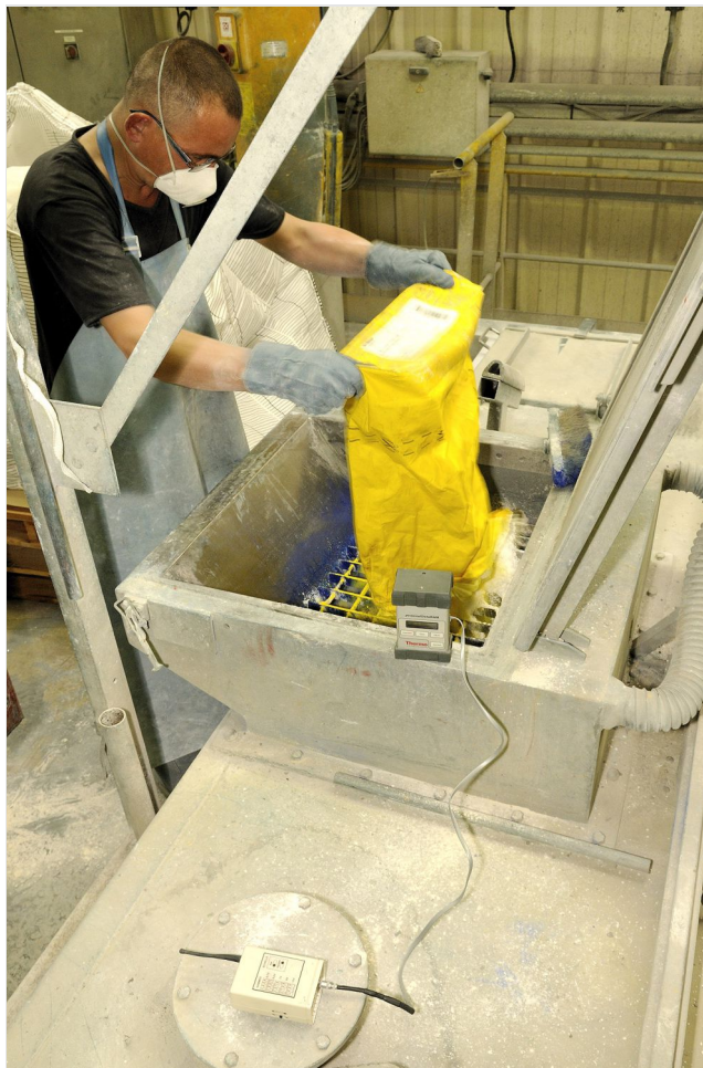
Détecteur pour analyser l'empoussièrement à un poste de désensachage
