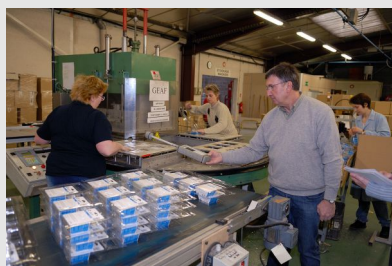
Mesure de champs électromagnétiques sur un poste de conditionnement utilisant un procédé de soudage à haute fréquence par pertes diélectriques
