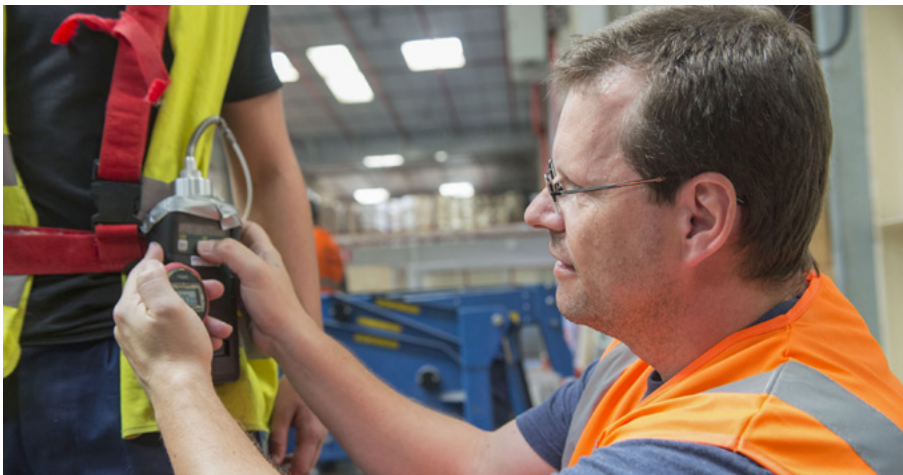
■ Installation d'un détecteur de gaz sur la ceinture d'un opérateur chargé de dépoter un conteneur.
