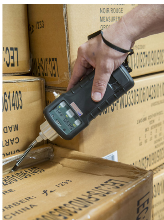
■ Vérification de la possible présence de gaz dans un conteneur à l'aide d'un détecteur de gaz.
