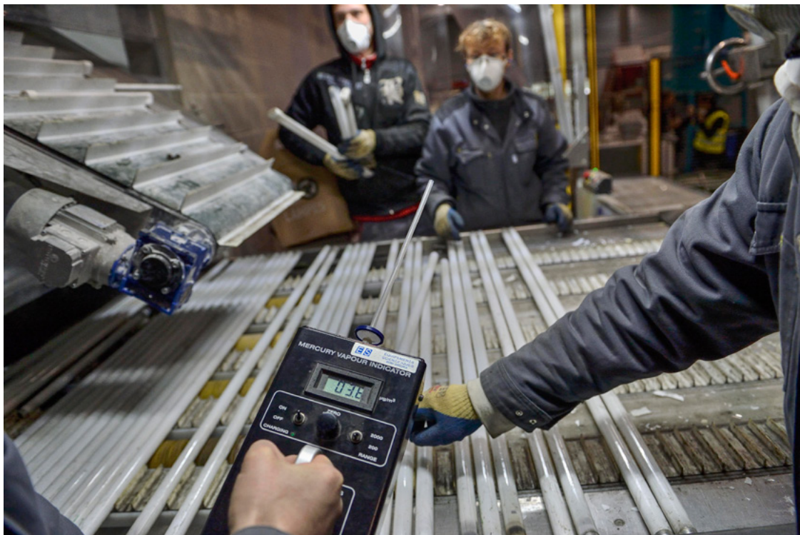
■ Mesure des vapeurs de mercures à un poste de chargement d'une chaîne de dépollution des lampes.
